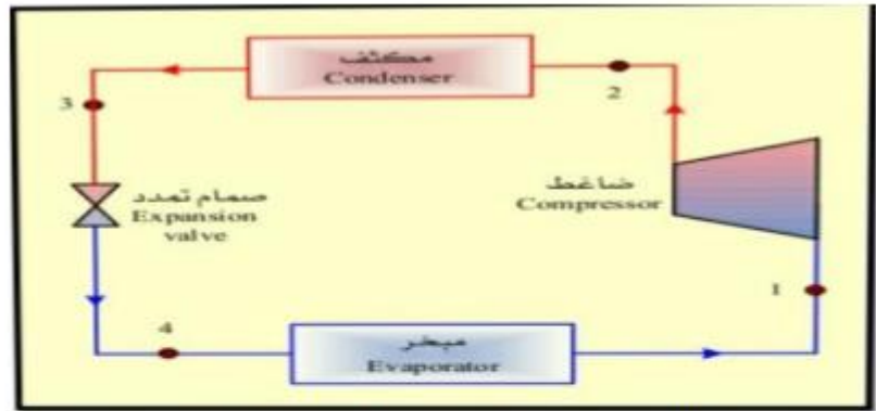
الشكل (1-1) مخطط الانسياب لدورة التبريد العادية [6]
