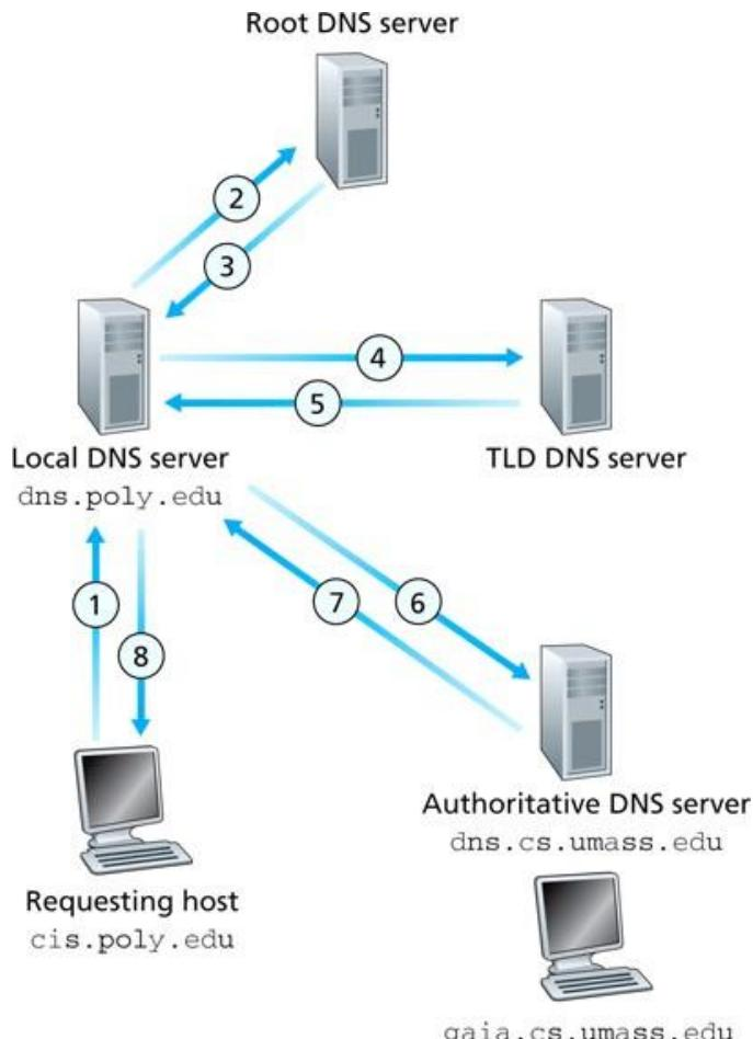
يمكن أن نشرح مبدأ عمل المحلل Resolver خطوة بخطوة وبشكل مبسط: ( المثال الوارد في الشكل السابق )
