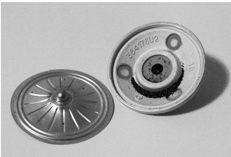
يعتمد عمل الميكروفون الكريبو على تغير المقاومة الكهربائية لحببات الكربون تبعاً للضغط الناتج عن الصوت.
