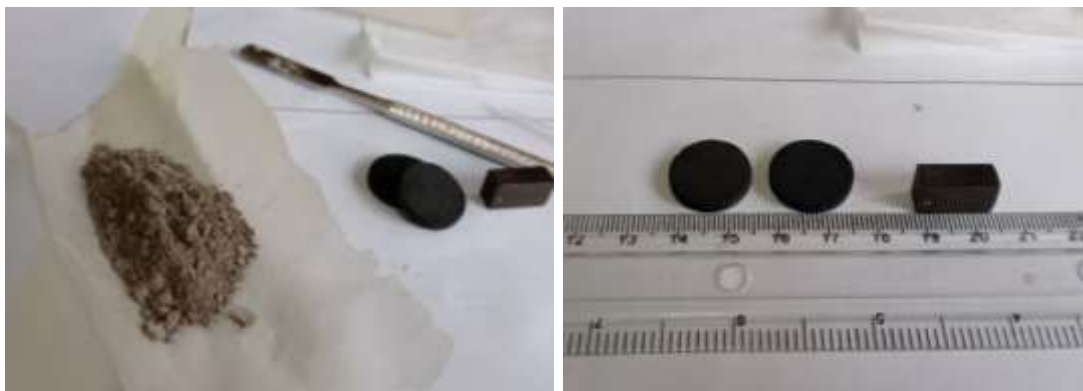
الشكل (4-14): العيّنات النقية والمشاببة بعد عملية الكبس
