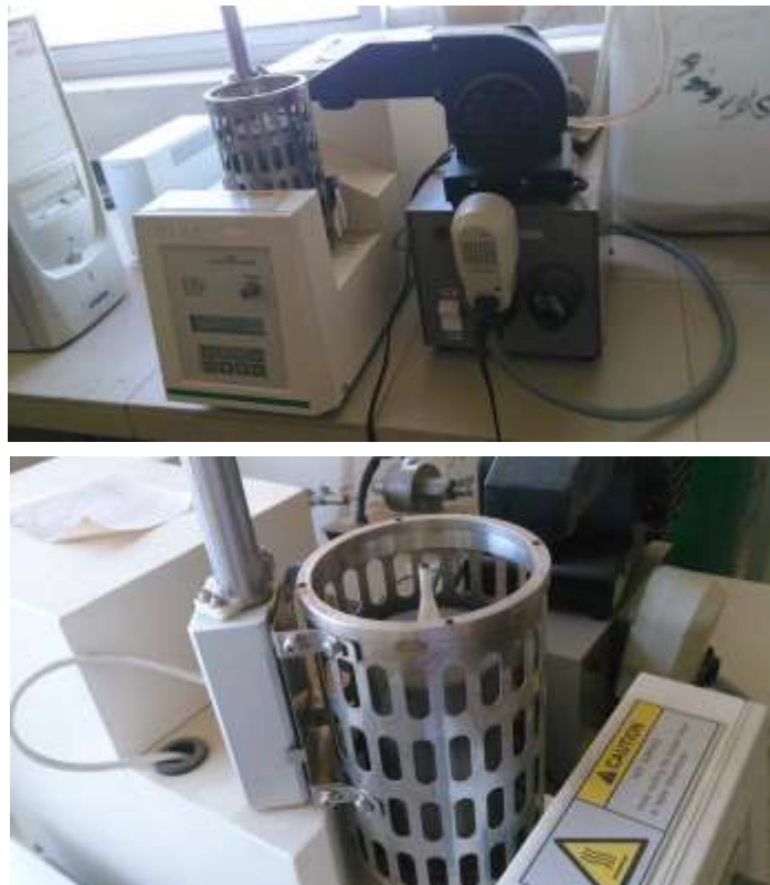
الشكل (4-11) جهاز التحليل الحراري التفاضلي DTA.
