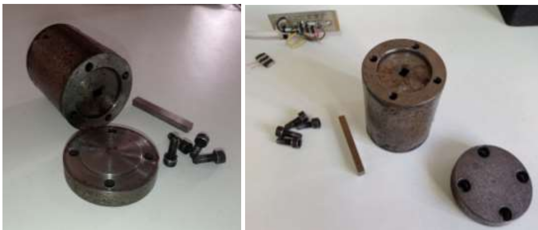
الشكل (4-13): قالب من الفولاذ المقسى يعطي عينات بشكل متوازي مستطيلات أبعادها (6 - 8 - 30) \text{ mm} .
