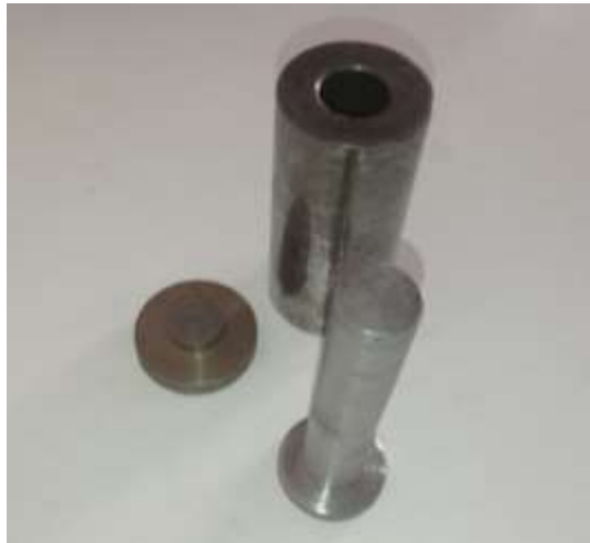
الشكل(4-12): قالب من الفولاذ النقي يعطي عينات على شكل أقراص بقطر 1cm
