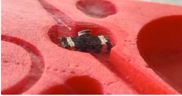
الشكل (5-39): ظاهرة أثر مايسنر لأحد العينات فائقة الناقلية المحضّرة.
