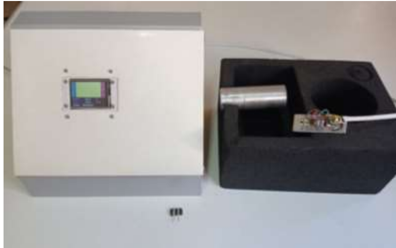
الشكل(4-10): جهاز قياس المقاومة الكهربائية في درجات الحرارة المنخفضة.
