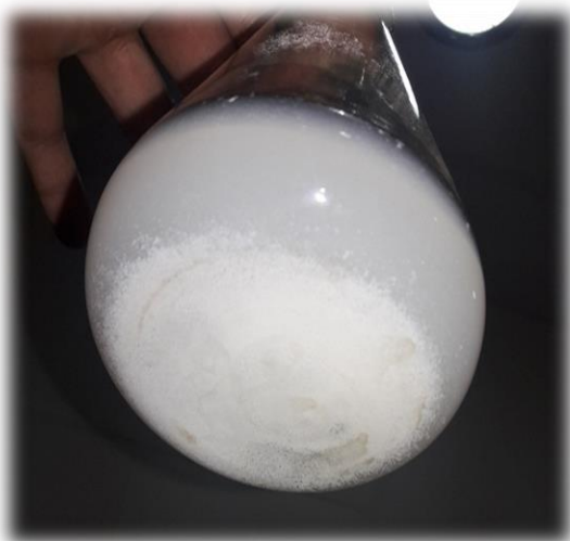
الشكل 9: ترسب مسحوق صلب أثناء تحضير العينات C1,1 , C 1,3
