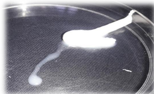
الشكل 11: بدء انفصال الأطوار في D3,1 بعد الفتح بـ 9 أسابيع
