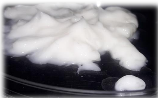
الشكل 12: بدء انفصال الأطوار في C3,3 بعد الفتح بـ 6 أسابيع
