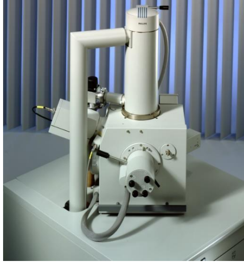
الشكل (٩-٢) المجهر الماسح الإلكتروني SEM Quanta 200.
