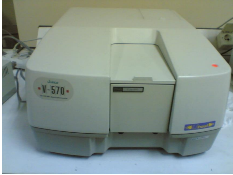
الشكل (٢-١٠) صورة لجهاز المقياس الطيفي.
