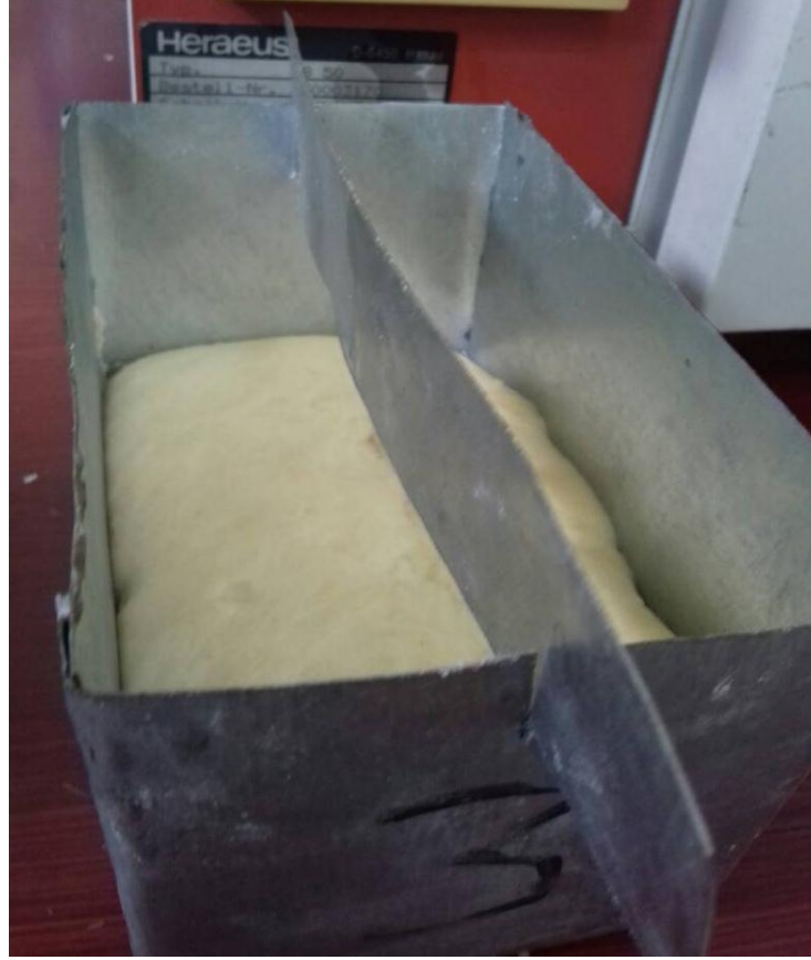
الشكل (11) ارتفاع العجينة في قالب تجربة القوة الناهضة
