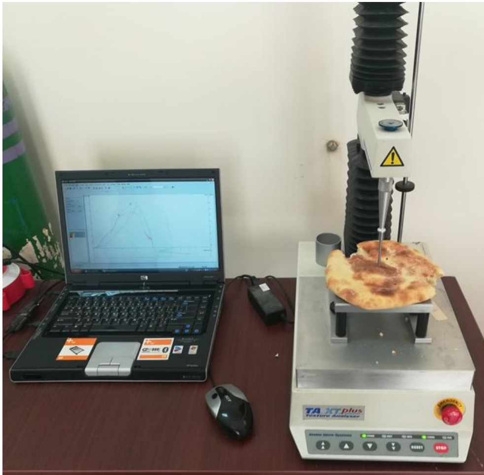
الشكل (7) جهاز قياس الصلابة
