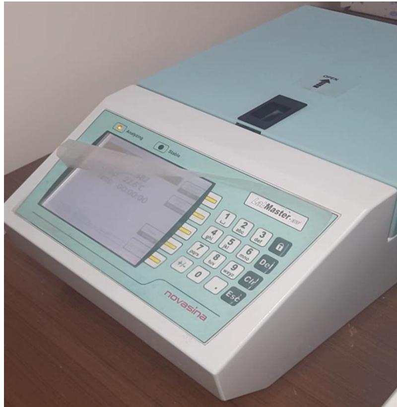
الشكل (8) جهاز قياس النشاط المائي
