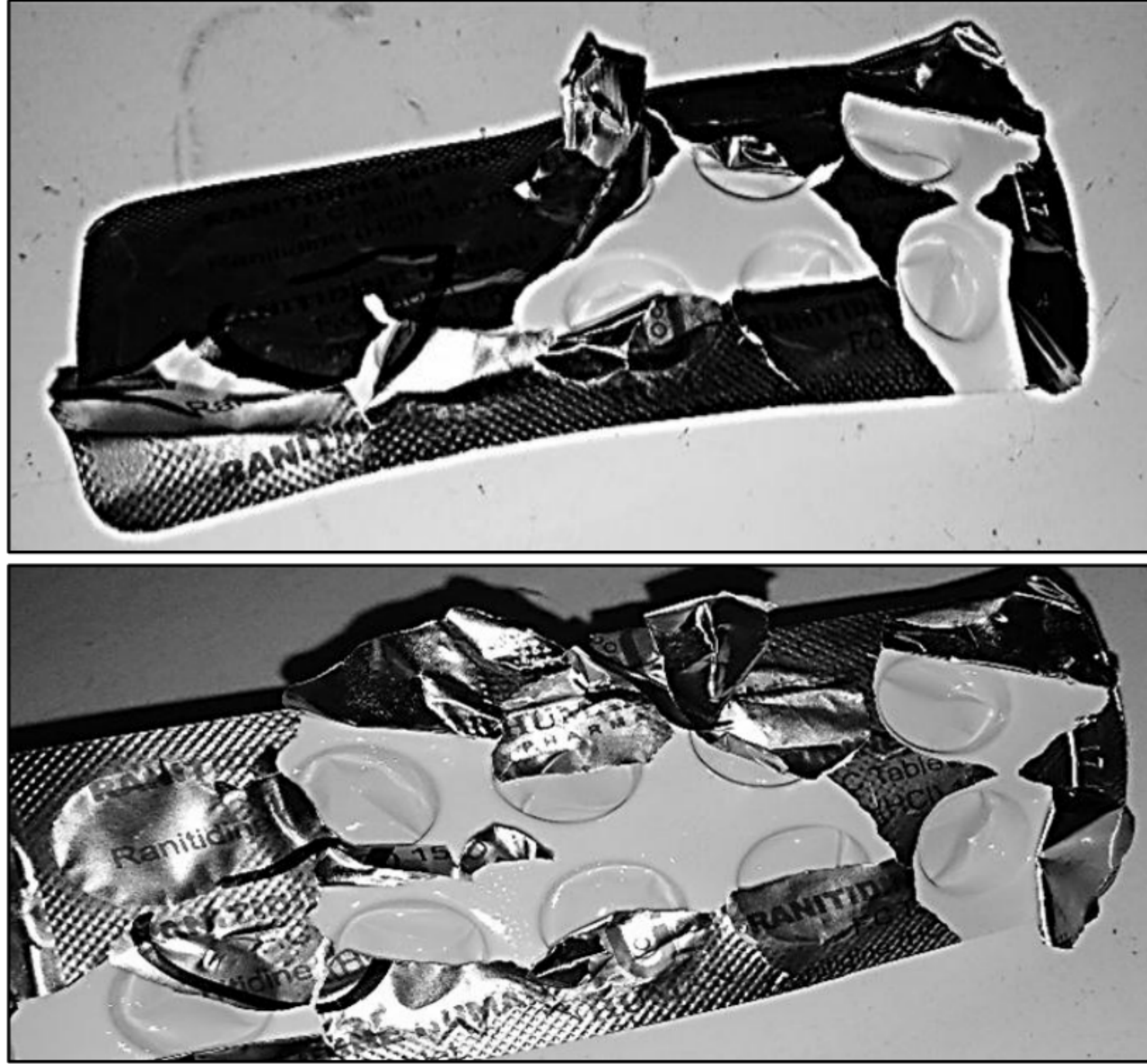
الشكل 8: سوء التحام طبقتي الحاوية الدوائية للطبخت D2, D3
