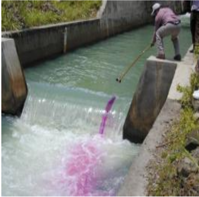
الشكل (2-4) يبين استخدام متتبع اصطناعي لتحديد مصدر التسرب
