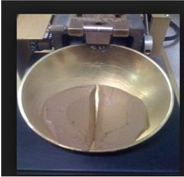
الشكل (3-45) جهاز تحديد السيولة
