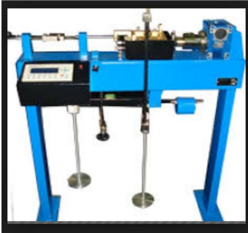
الشكل (3-46) جهاز القص المباشر
