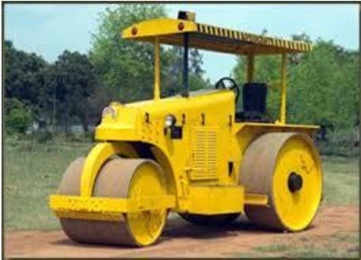
الشكل (2) نموذج من مداحل ذات عجلات فولاذية ملساء
