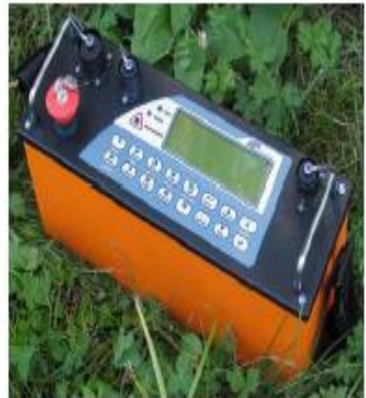
الشكل (11-2) الجهاز الجيوكهربائي ARES
