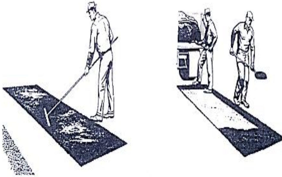
الشكل (17) صيانة التشققات و الحفر
