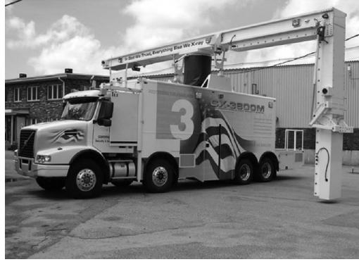
الشكل (5-2): جهاز تصوير بالأشعة السينية محمول على شاحنة
