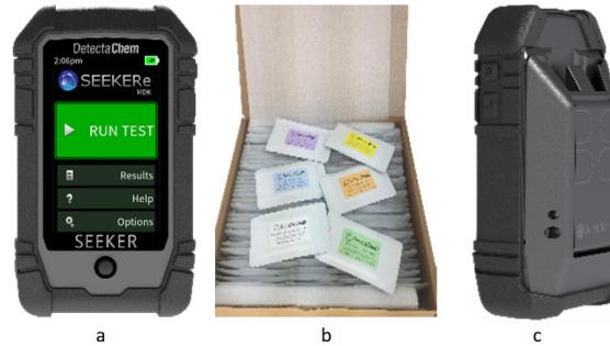
الشكل (2-2): جهاز كشف المتفجرات يستند إلى الكشف اللوني (Colorimetric)
