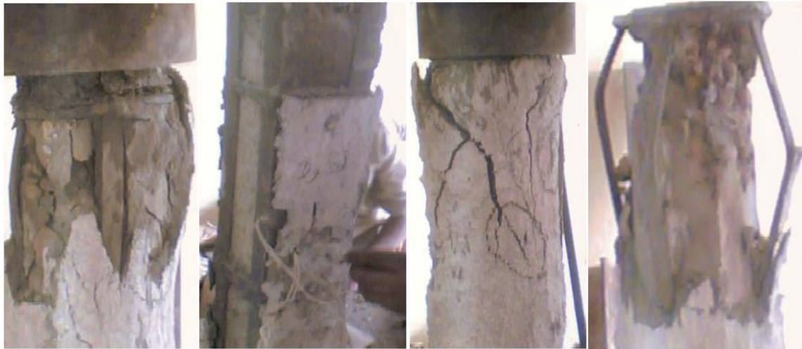
الشكل (12-2) بعض نماذج الانهيار للأعمدة المدعمة
