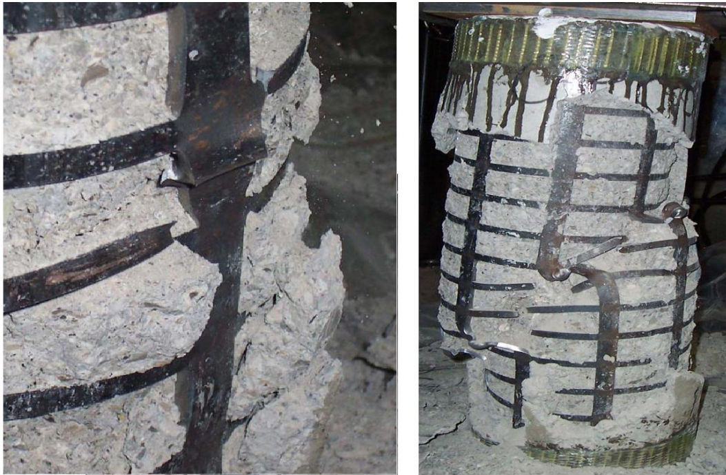
الشكل (26-2) بعض أنماط الانهيار للأعمدة المدعمة بتقنية القميص البيتوني المسلح بقفص بيتوني.
