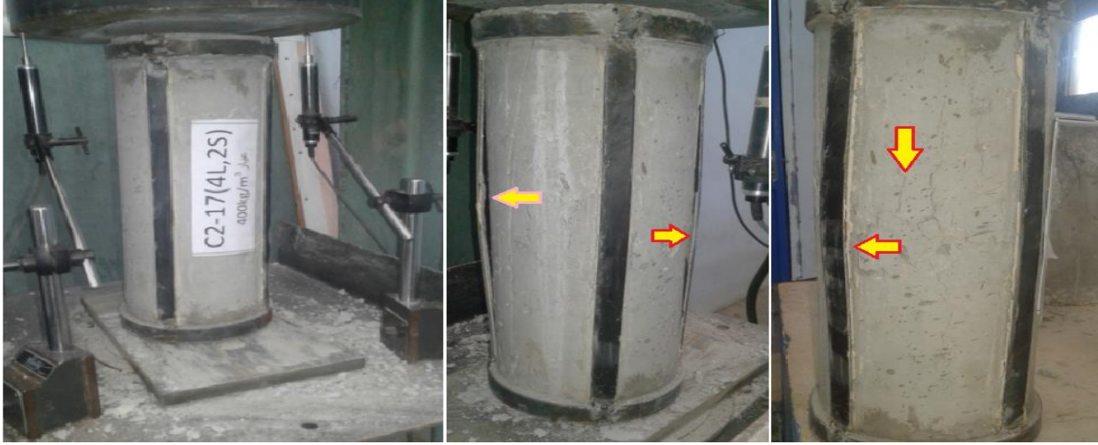
الشكل (66-3) مراحل التحميل وشكل الانهيار للعمود البيتوني المسلح المدعم C2-17
