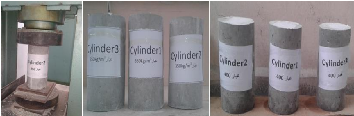
الشكل (3-10) العينات الاسطوانية المجربة على عمر 28 يوماً وتحميل إحدى العينات
