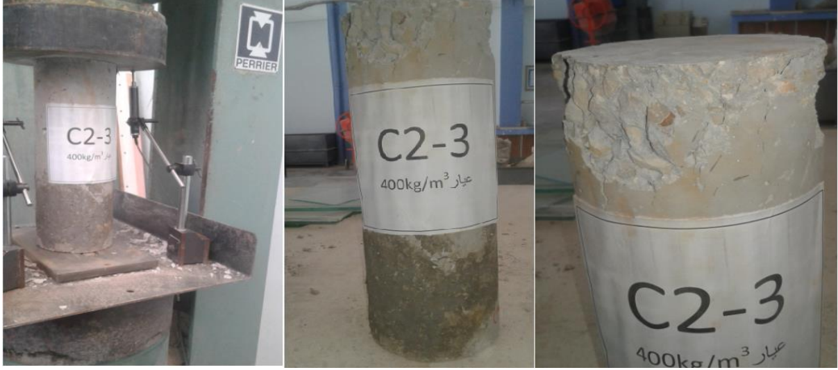
الشكل (52-3) مراحل التحميل وشكل الانهيار للعمود البيتوني المسلح المرجعي C2-3 3-2-6-2- مجموعة الأعمدة المدعمة بثلاثة صفائح عرضية وأربع صفائح شاقولية (2-4L-3S):
