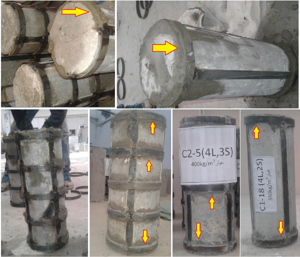
الشكل (30-3) بعض نماذج الأعمدة البيتونية التي استخدمت فيها مادة Polycrret-FBR كمادة مالئة
