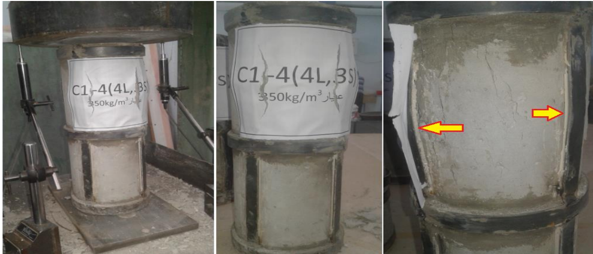
الشكل (35-3) مراحل التحميل وشكل الانهيار للعمود البيتوني المسلح المدعم C1-4
