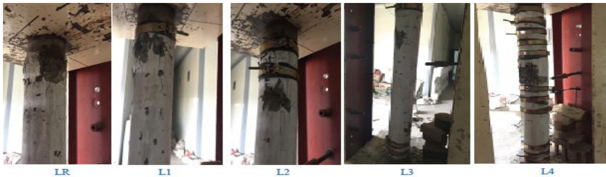
الشكل (2-5) نماذج الانهيار للأعمدة الطويلة المختبرة من قبل الباحثين [5]
