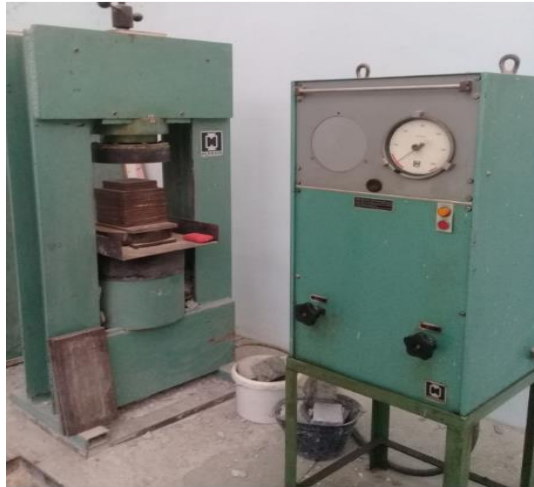
الشكل (3-18) جهاز تجريب العينات الاسطوانية في مخبر مواد البناء - كلية الهندسة المدنية بجامعة البعث
