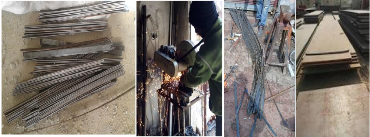
الشكل (23-3) مراحل تشكيل الصفائح الفولاذية الطولية
