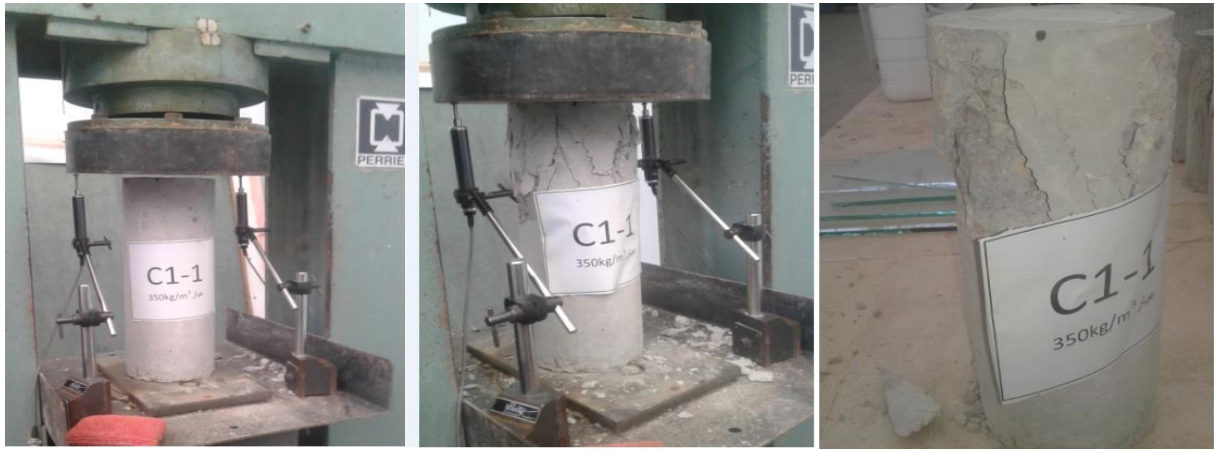
الشكل (32-3) مراحل التحميل وشكل الانهيار للعمود البيتوني المسلح المرجعي C1-1
