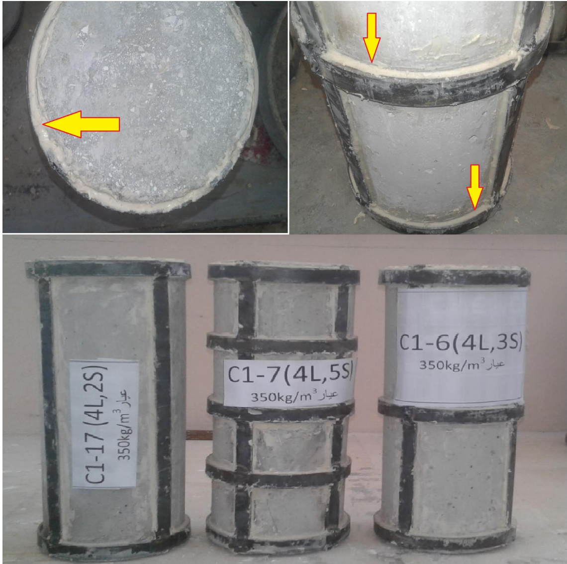
الشكل (29-3) بعض الأعمدة البيتونية المسلحة التي استخدمت فيها مادة مالينات البولستر كمادة مالئة
