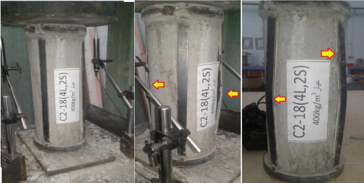
الشكل (67-3) مراحل التحميل وشكل الانهيار للعمود البيتوني المسلح المدعم C2-18
