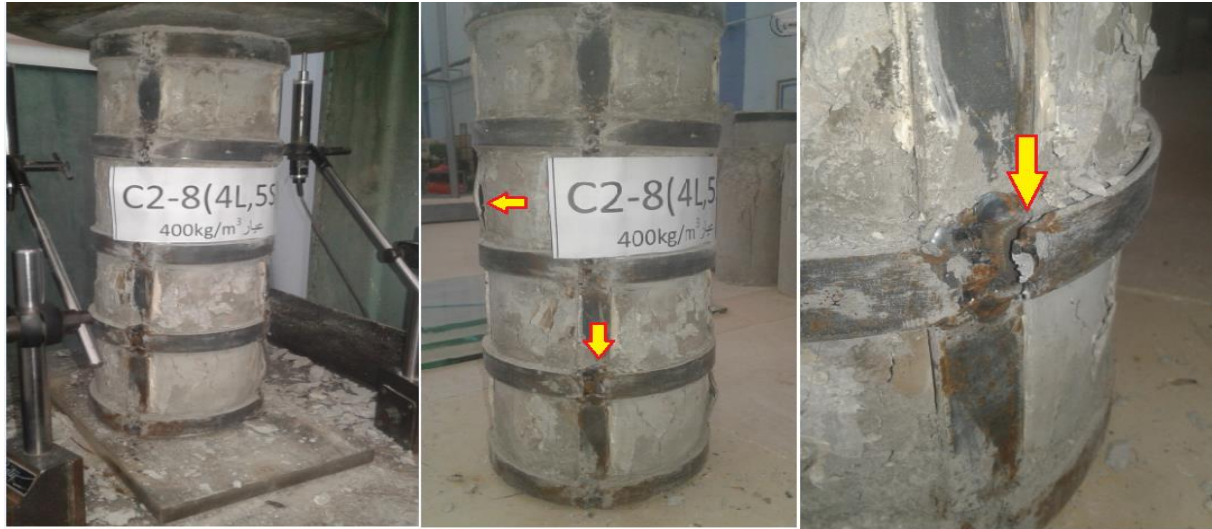
الشكل (57-3) مراحل التحميل وشكل الانهيار للعمود البيتوني المسلح المدعم C2-8
