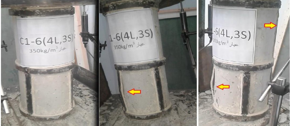
الشكل (37-3) مراحل التحميل وشكل الانهيار للعمود البيتوني المسلح المدعم C1-6
