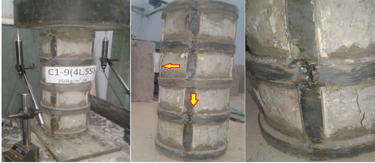
الشكل (40-3) مراحل التحميل وشكل الانهيار للعمود الببتوني المسلح المدعم C1-9
