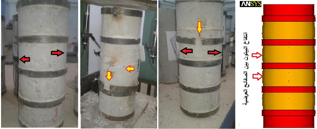
الشكل (5-16) مقارنة شكل الانهيار للنموذج العددي باستخدام برنامج ANSYS مع شكل الانهيار للأعمدة المماثلة المجربة مخبرياً
