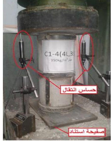
الشكل (19-3) مواقع الحساسات ونموذج التحميل للأعمدة المجربة
