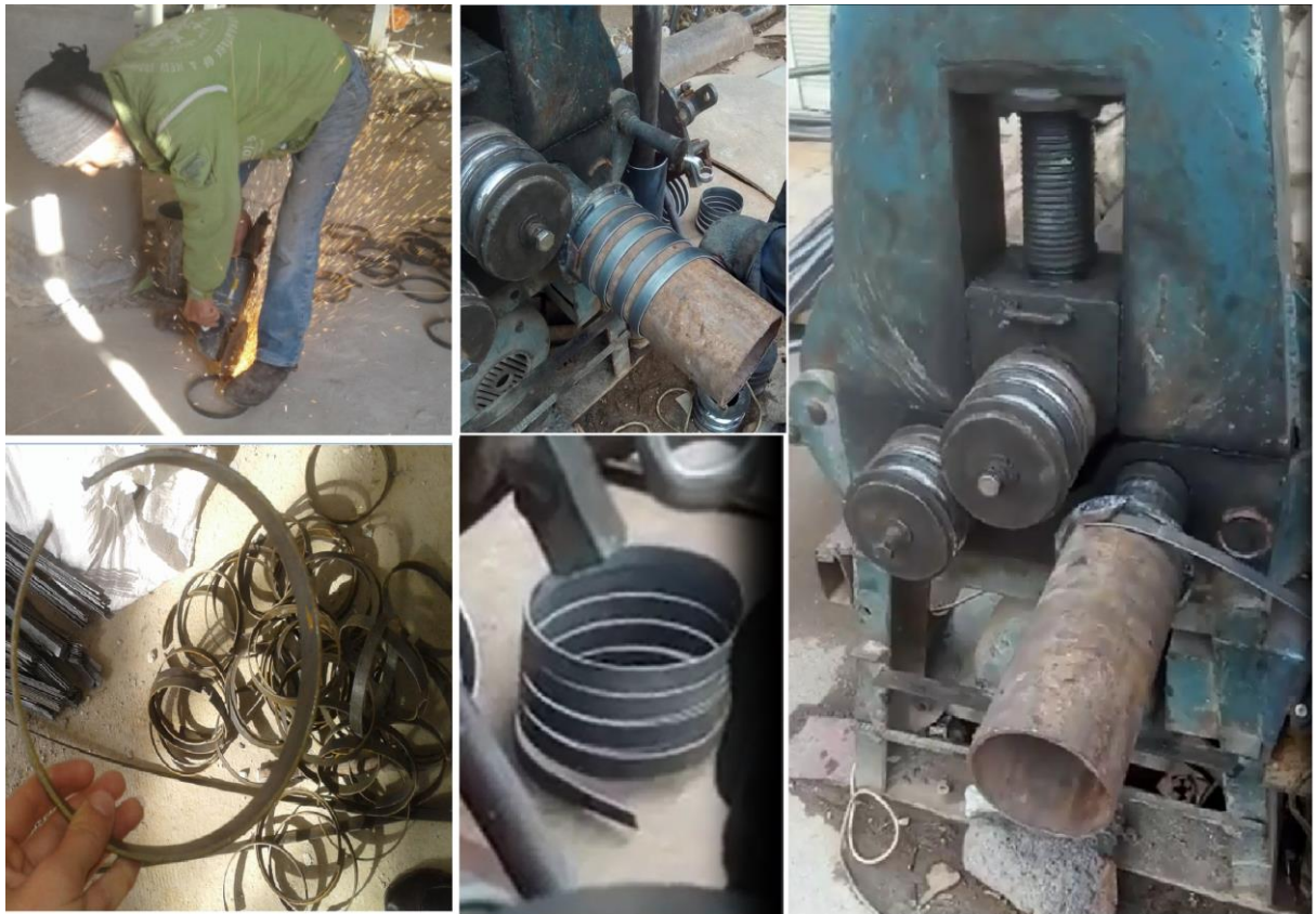
الشكل (24-3) مراحل تشكيل الحلقات الفولاذية العرضية
