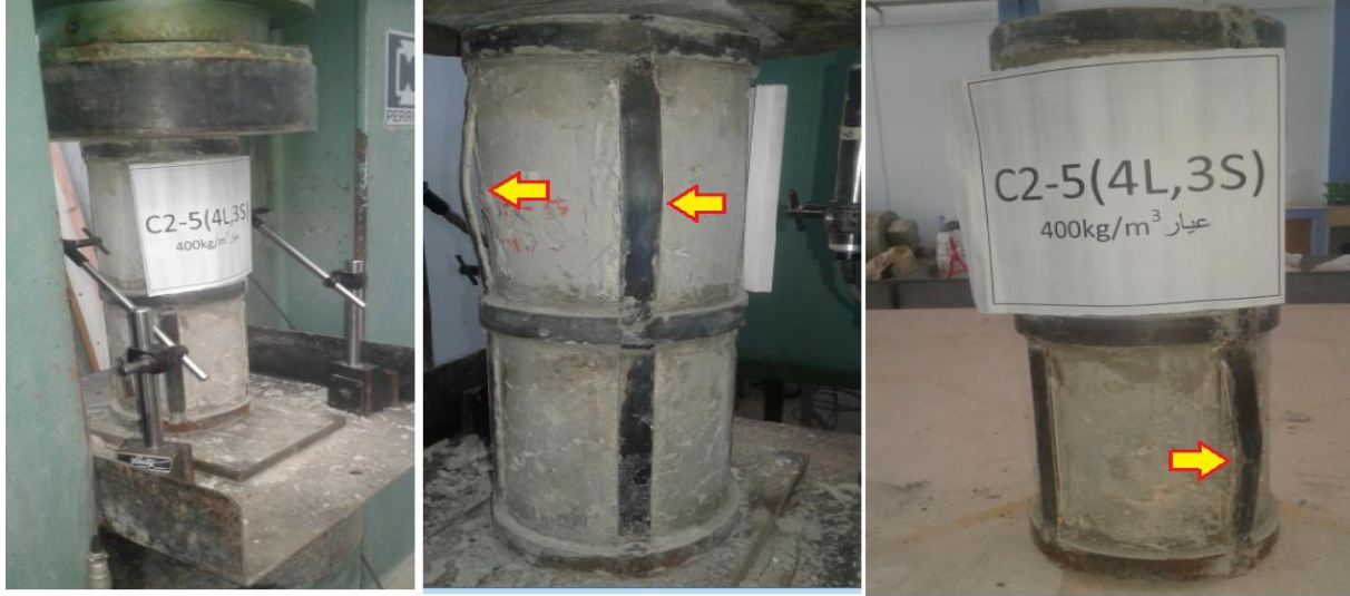
الشكل (54-3) مراحل التحميل وشكل الانهيار للعمود الببتوني المسلح المدعم C2-5
