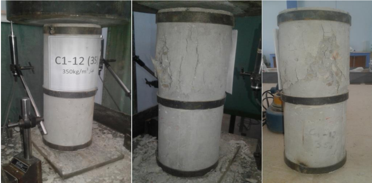
الشكل (43-3) مراحل التحميل وشكل الانهيار للعمود الببتوني المسلح المدعم C1-12
