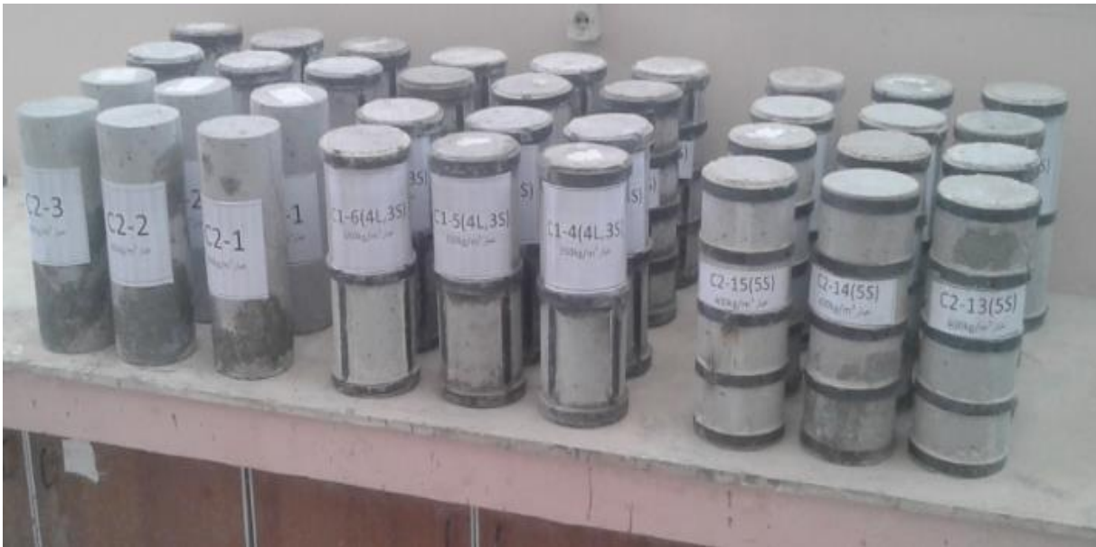
الشكل (31-3) الأعمدة البيتونية المدعمة والمرجعية قبل اختبارها
