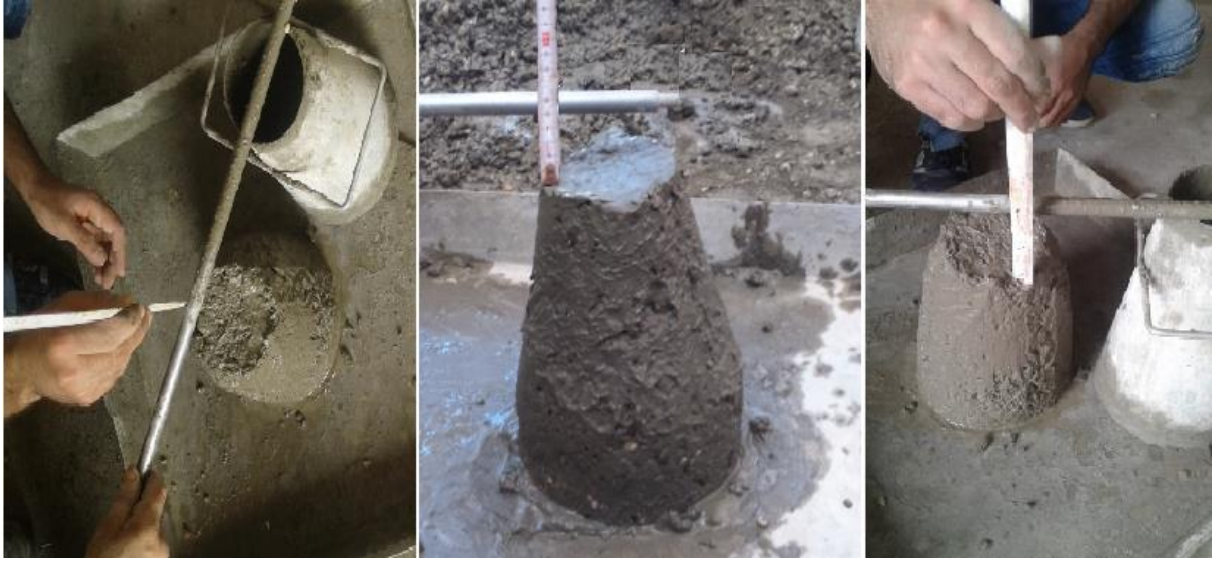
الشكل (3 - 9) تجربة هبوط مخروط أبرامز وقوام الخلطين البيتونيتين التجريبيتين
