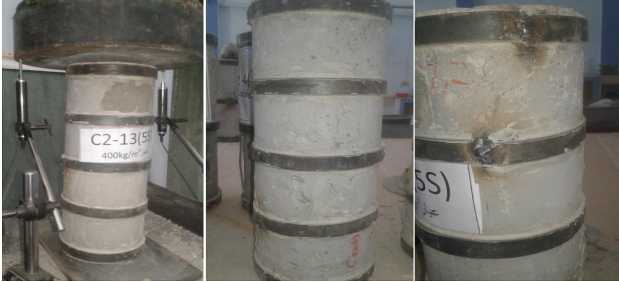
الشكل (62-3) شكل الانهيار للعمود البيتوني المسلح المدعم C2-13
