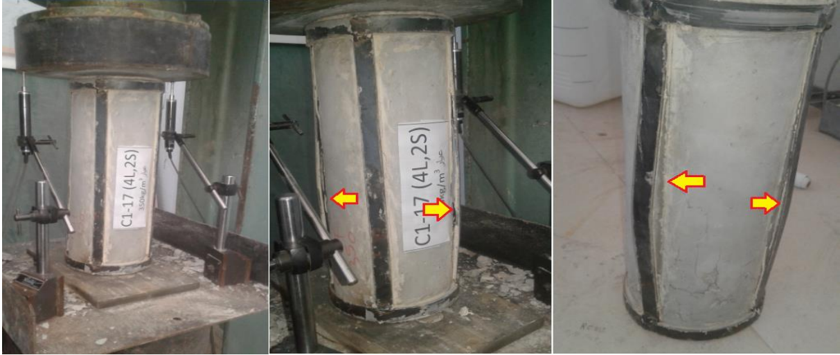
الشكل (48-3) مراحل التحميل وشكل الانهيار للعمود البيتوني المسلح المدعم C1-17
