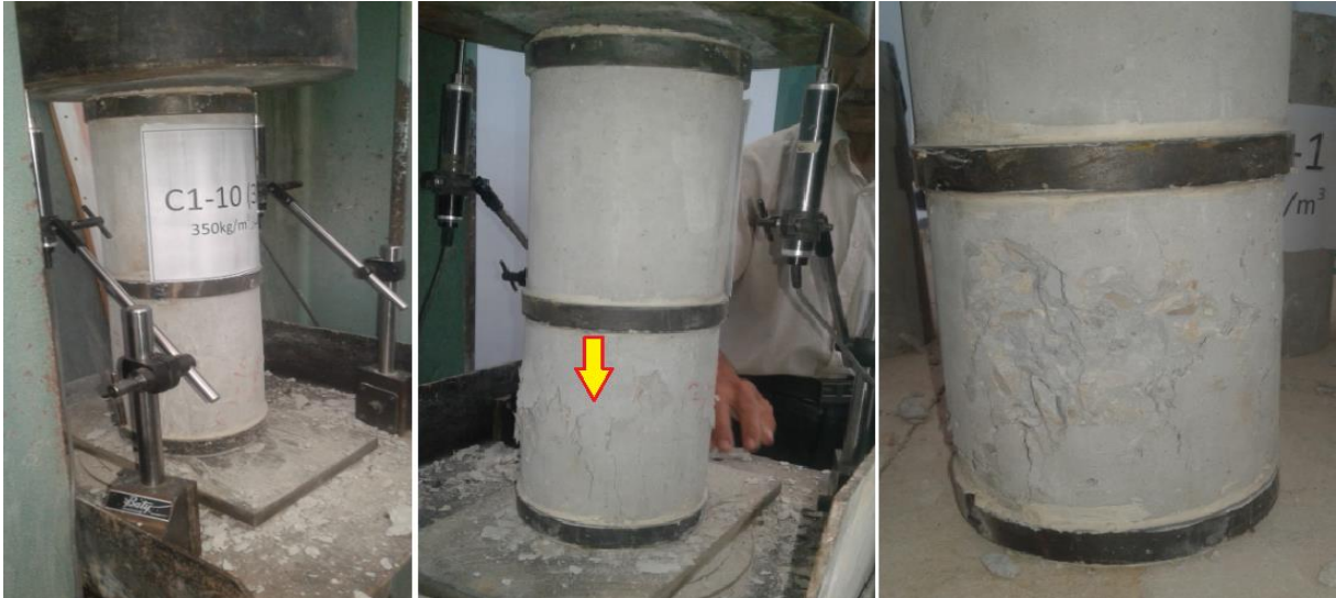
الشكل (41-3) مراحل التحميل وشكل الانهيار للعمود الببتوني المسلح المدعم C1-10
