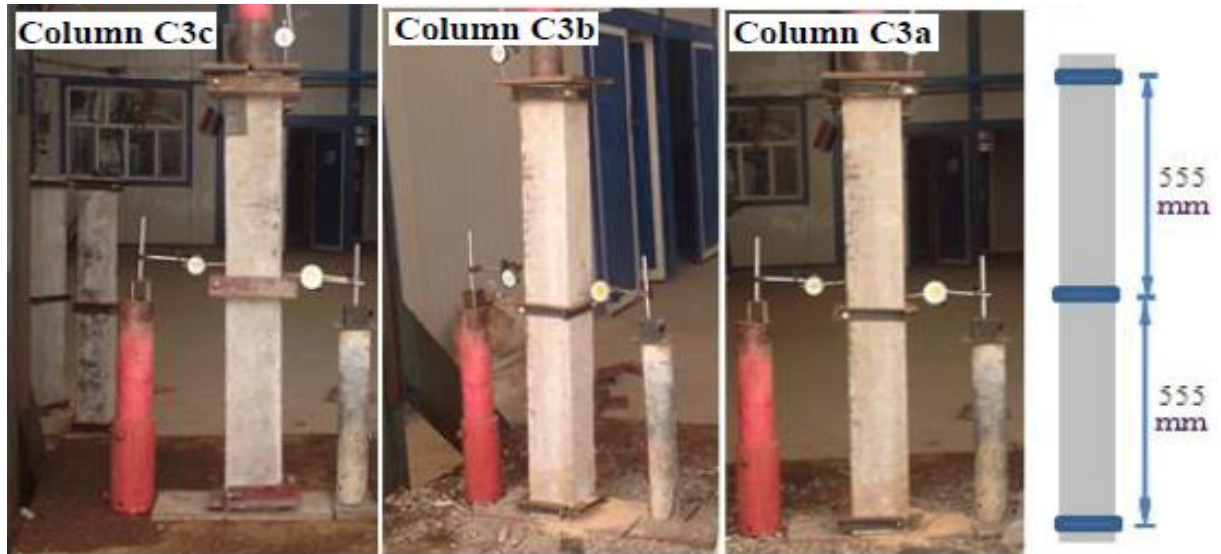
الشكل (16-2) الأعمدة المستخدمة لدراسة تأثير أبعاد عناصر الطوق الفولاذي من قبل الباحثة [7]
