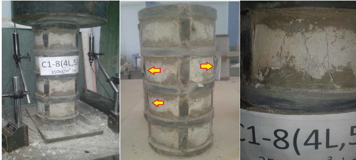
الشكل (39-3) مراحل التحميل وشكل الانهيار للعمود البيتوني المسلح المدعم C1-8
