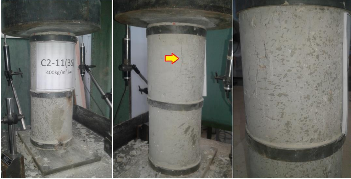
الشكل (60-3) مراحل التحميل وشكل الانهيار للعمود الببتوني المسلح المدعم C2-11
