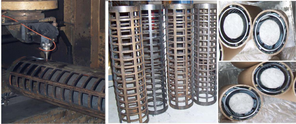
توضع الأقفاص في منتصف القميص البيتوني الأقفاص الفولاذية الجاهزة لتسليح القميص البيتوني تشكيل الأقفاص الفولاذية بتقنية القطع بالليزر الشكل (25-2) خطوات صناعة القفص الفولاذي وشكل توضع ضمن القميص البيتوني للأعمدة المدعمة
