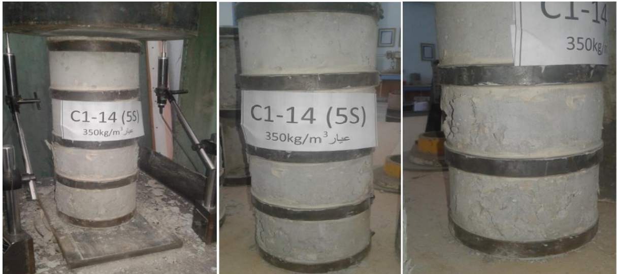
الشكل (3-45) مراحل التحميل وشكل الانهيار للعمود البيتوني المسلح المدعم C1-14
