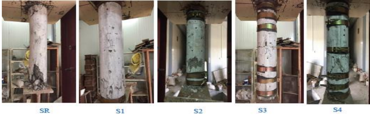
الشكل (2-4) نماذج الانهيار للأعمدة القصيرة المختبرة من قبل الباحثين [5]
