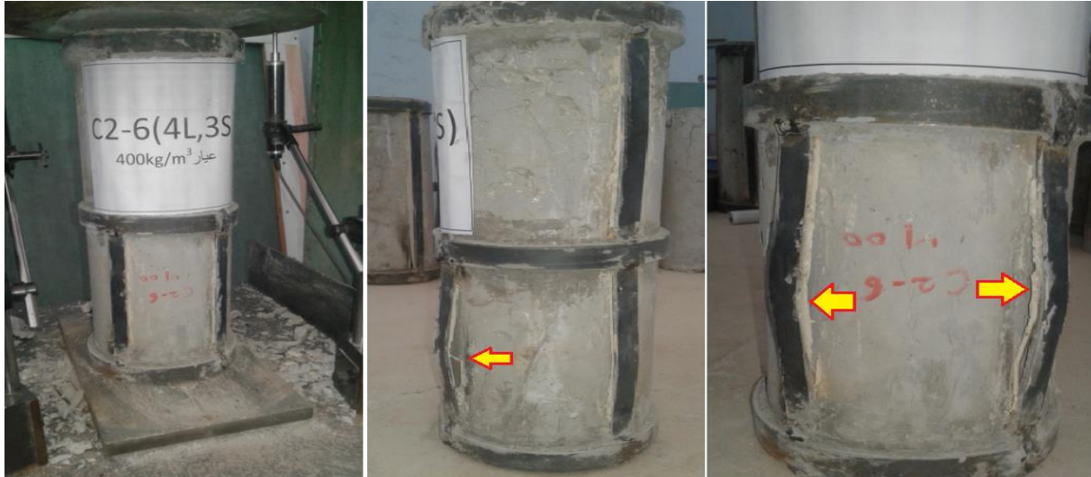
الشكل (55-3) مراحل التحميل وشكل الانهيار للعمود الببتوني المسلح المدعم C2-6
