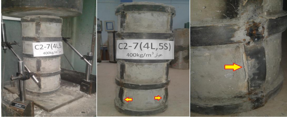
الشكل (56-3) مراحل التحميل وشكل الانهيار للعمود البيتوني المسلح المدعم C2-7
