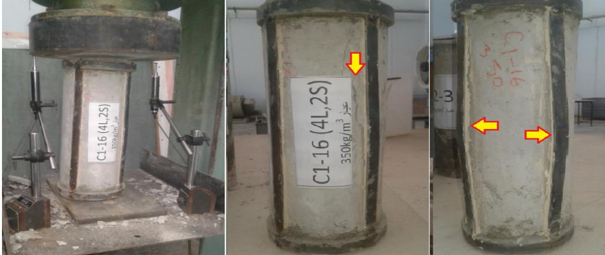
الشكل (47-3) مراحل التحميل وشكل الانهيار للعمود البيتوني المسلح المدعم C1-16
