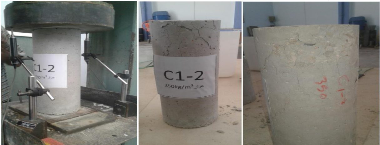
الشكل (33-3) مراحل التحميل وشكل الانهيار للعمود البيتوني المسلح المرجعي C1-2
