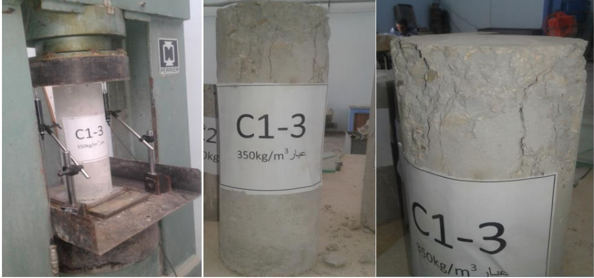
الشكل (34-3) مراحل التحميل وشكل الانهيار للعمود البيتوني المسلح المرجعي C1-3
