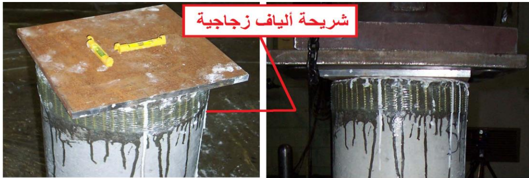
الشكل (21-2) تقوية الطرف العلوي للعمود المحمل وفق النمط C بشريحة الألياف الزجاجية
