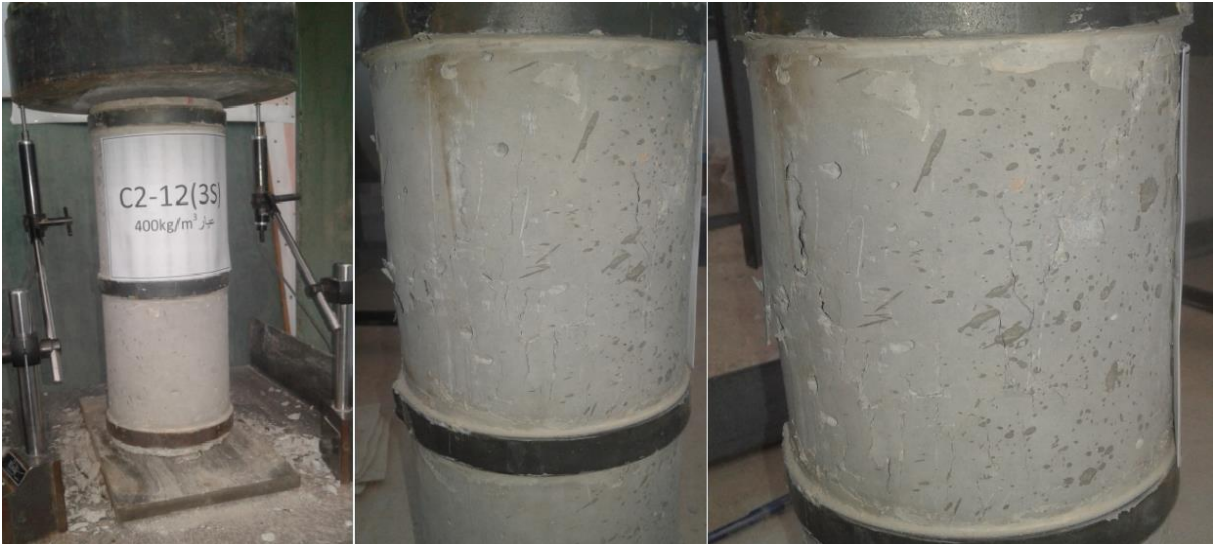
الشكل (61-3) مراحل التحميل وشكل الانهيار للعمود الببتوني المسلح المدعم C2-12
