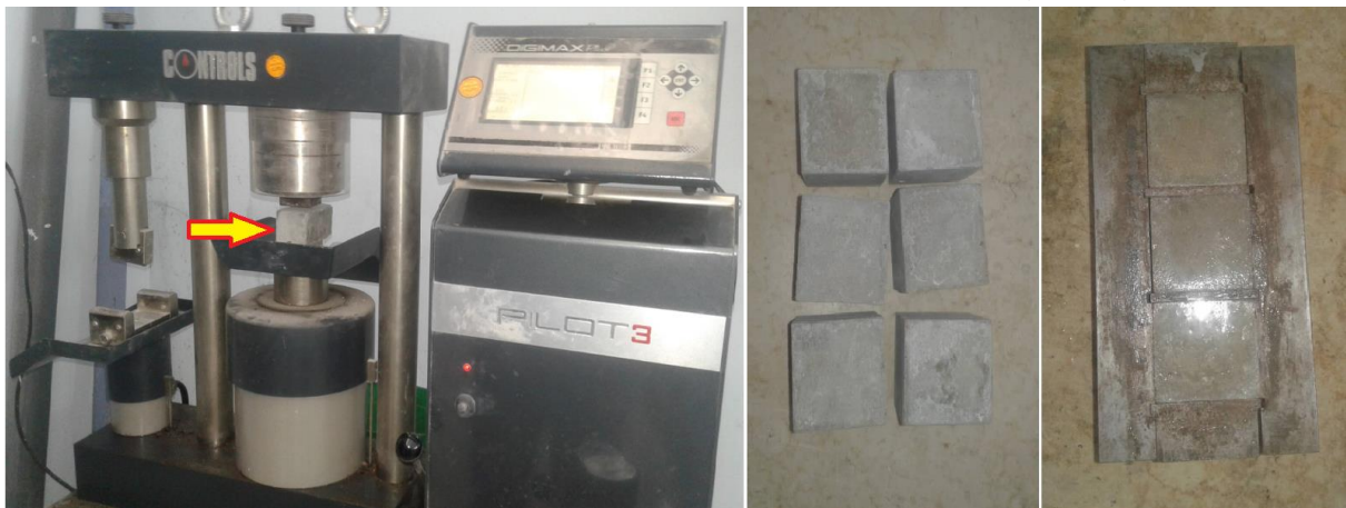
الشكل (3-17) العينات المكعبية لمادة Polycrete وجهاز اختبارها - مخبر مواد البناء
