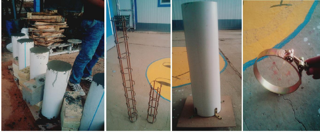
الشكل (2-2) نموذج حلقة التدعيم الميكانيكية المستخدمة للتدعيم وتفاصيل التسليح والقوالب المستخدمة لصب الاعمدة المختبرة
