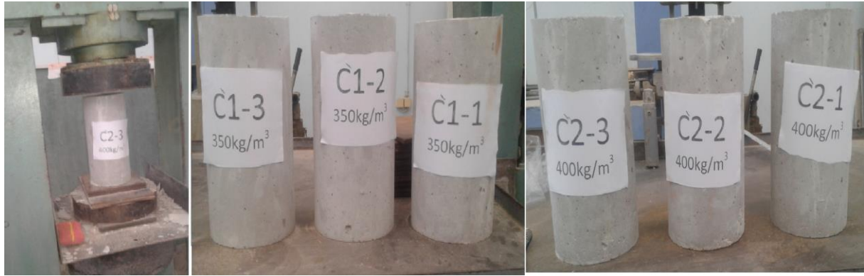
الشكل (3-11) العينات الاسطوانية المجربة على عمر 250 يوماً وتحمل إحدى العينات
