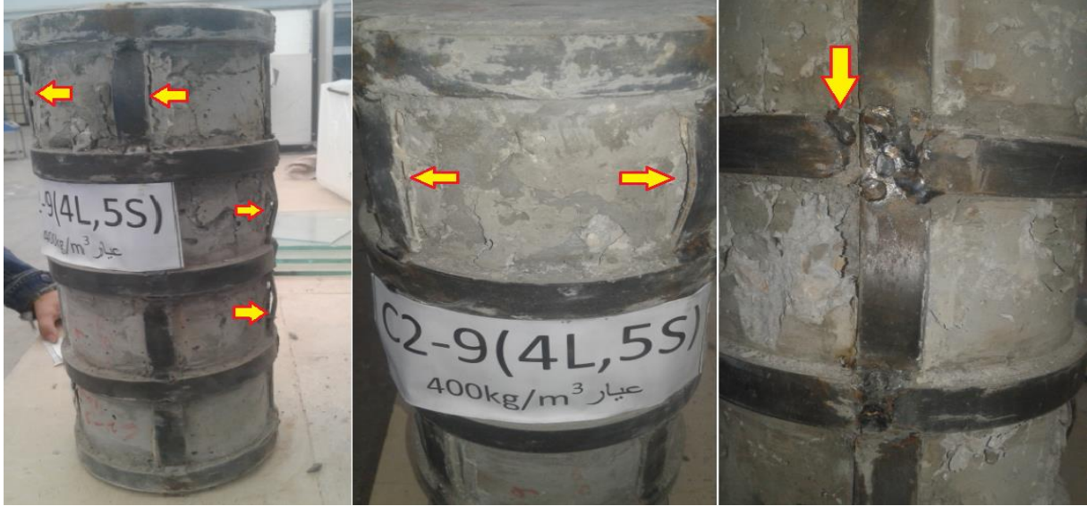
الشكل (58-3) مراحل التحميل وشكل الانهيار للعمود البيتوني المسلح المدعم C2-9
