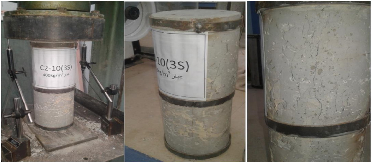
الشكل (59-3) مراحل التحميل وشكل الانهيار للعمود البيتوني المسلح المدعم C2-10
