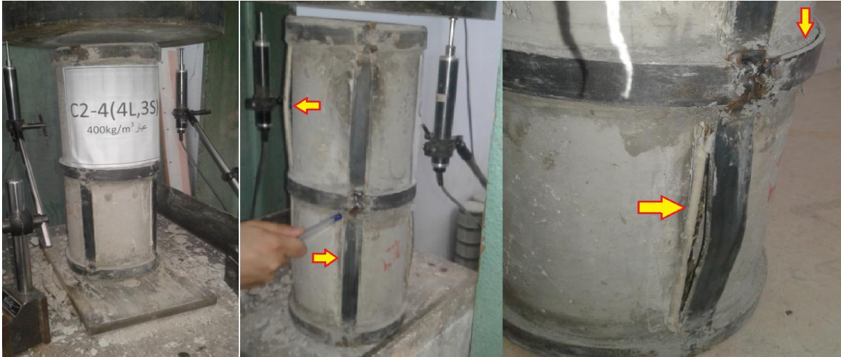
الشكل (53-3) مراحل التحميل وشكل الانهيار للعمود البيتوني المسلح المدعم C2-4
