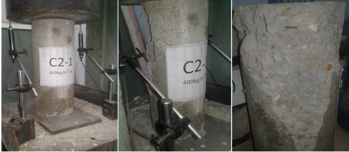
الشكل (3-50) مراحل التحميل وشكل الانهيار للعمود البيتوني المسلح المرجعي C2-1
