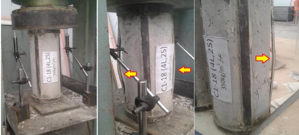
الشكل (49-3) مراحل التحميل وشكل الانهيار للعمود البيتوني المسلح المدعم C1-18
