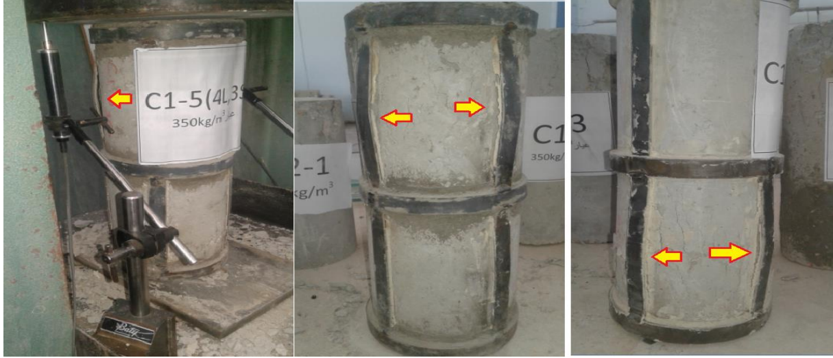
الشكل (36-3) مراحل التحميل وشكل الانهيار للعمود البيتوني المسلح المدعم C1-5
