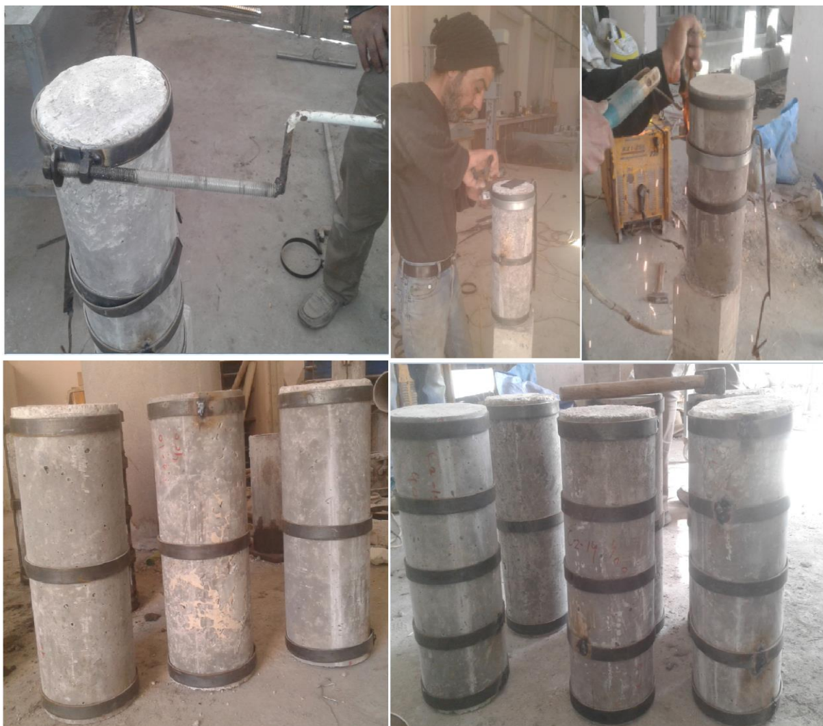
الشكل (26-3) مراحل تدعيم الأعمدة البيتونية الدائرية باستخدام الحلقات الفولاذية العرضية فقط
