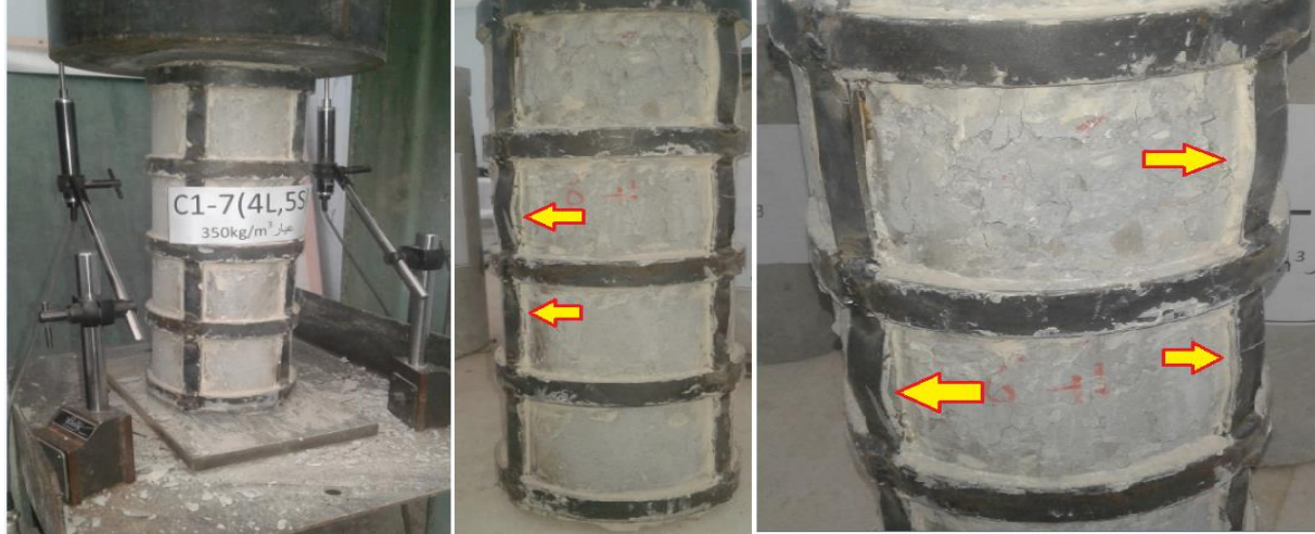
الشكل (38-3) مراحل التحميل وشكل الانهيار للعمود البيتوني المسلح المدعم C1-7
