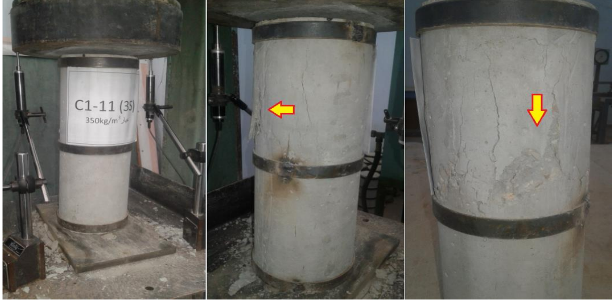
الشكل (42-3) مراحل التحميل وشكل الانهيار للعمود الببتوني المسلح المدعم C1-11
