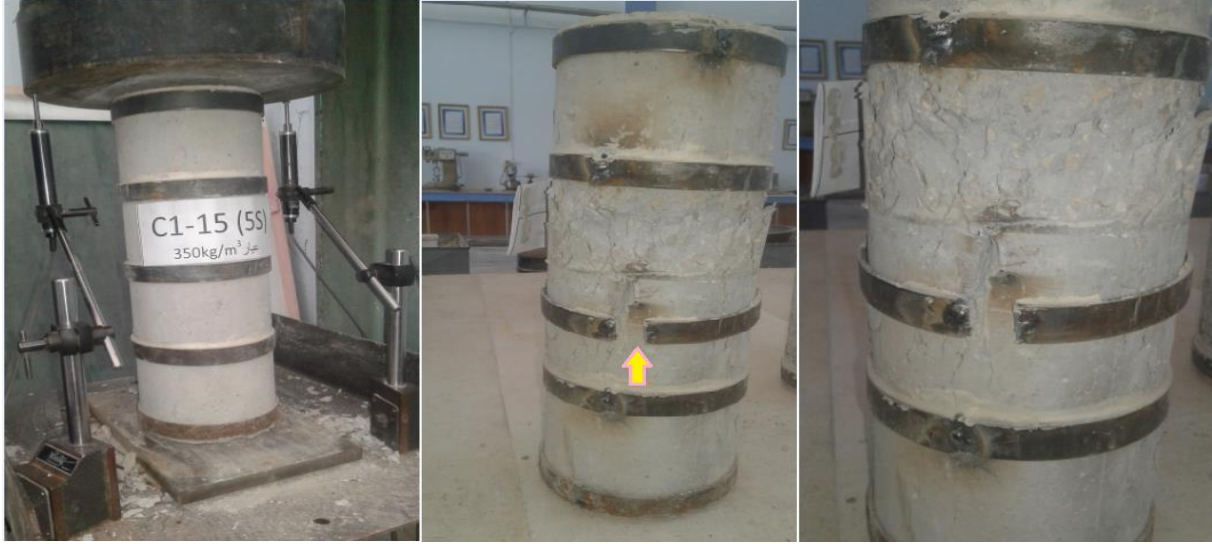
الشكل (46-3) مراحل التحميل وشكل الانهيار للعمود البيتوني المسلح المدعم C1-15
