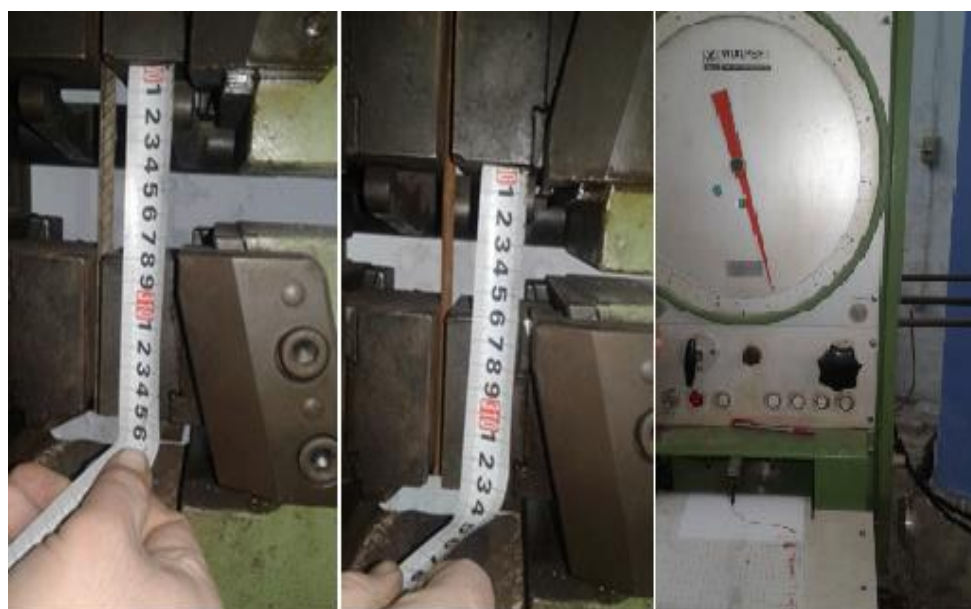
الشكل (3-12) نتائج تجربة شد فولاذ قضبان التسليح المستخدم
