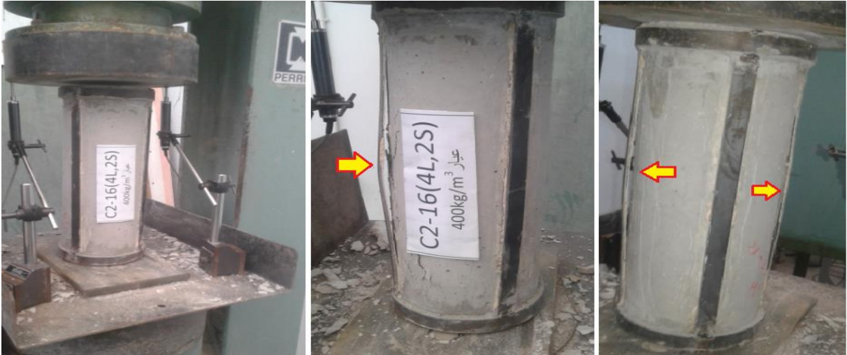
الشكل (65-3) مراحل التحميل وشكل الانهيار للعمود البيتوني المسلح المدعم C2-16
