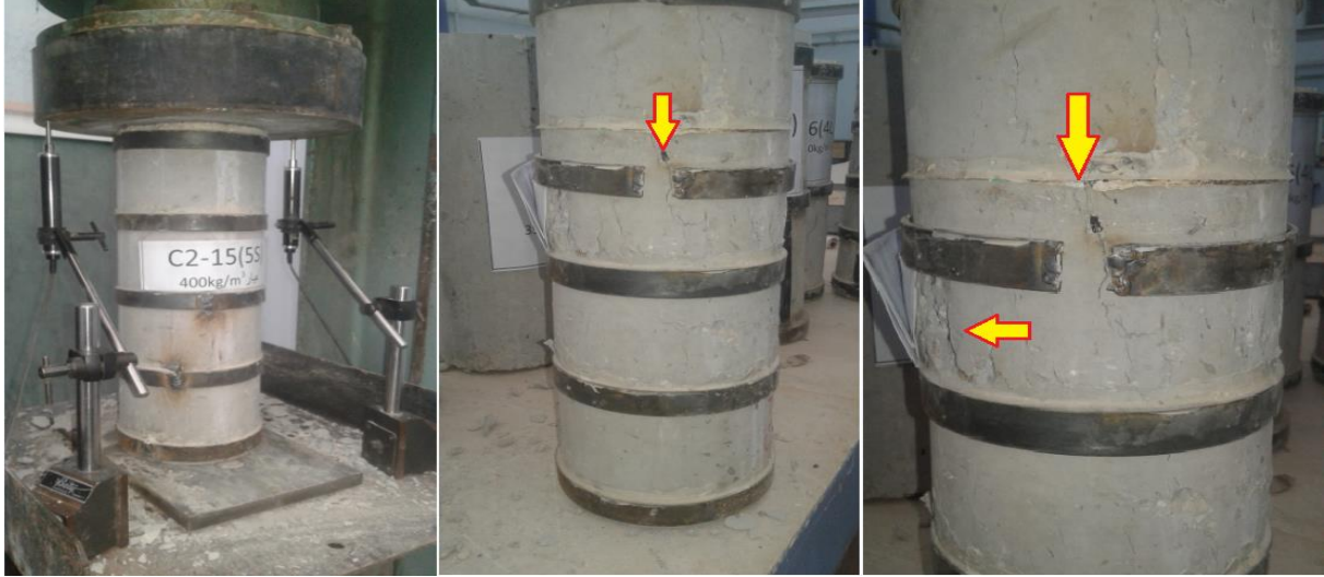
الشكل (64-3) مراحل التحميل وشكل الانهيار للعمود البيتوني المسلح المدعم C2-15
