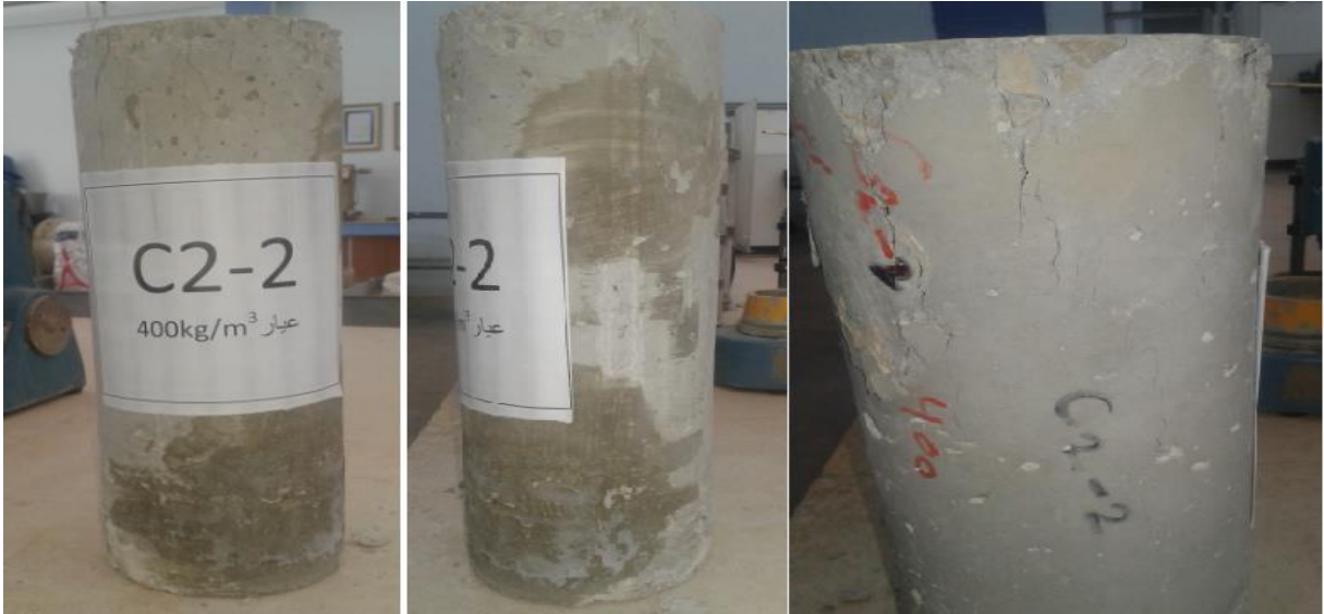
الشكل (3-51) مراحل التحميل وشكل الانهيار للعمود البيتوني المسلح المرجعي C2-2
