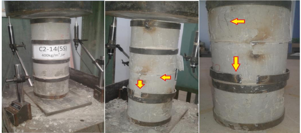
الشكل (63-3) مراحل التحميل وشكل الانهيار للعمود البيتوني المسلح المدعم C2-14
