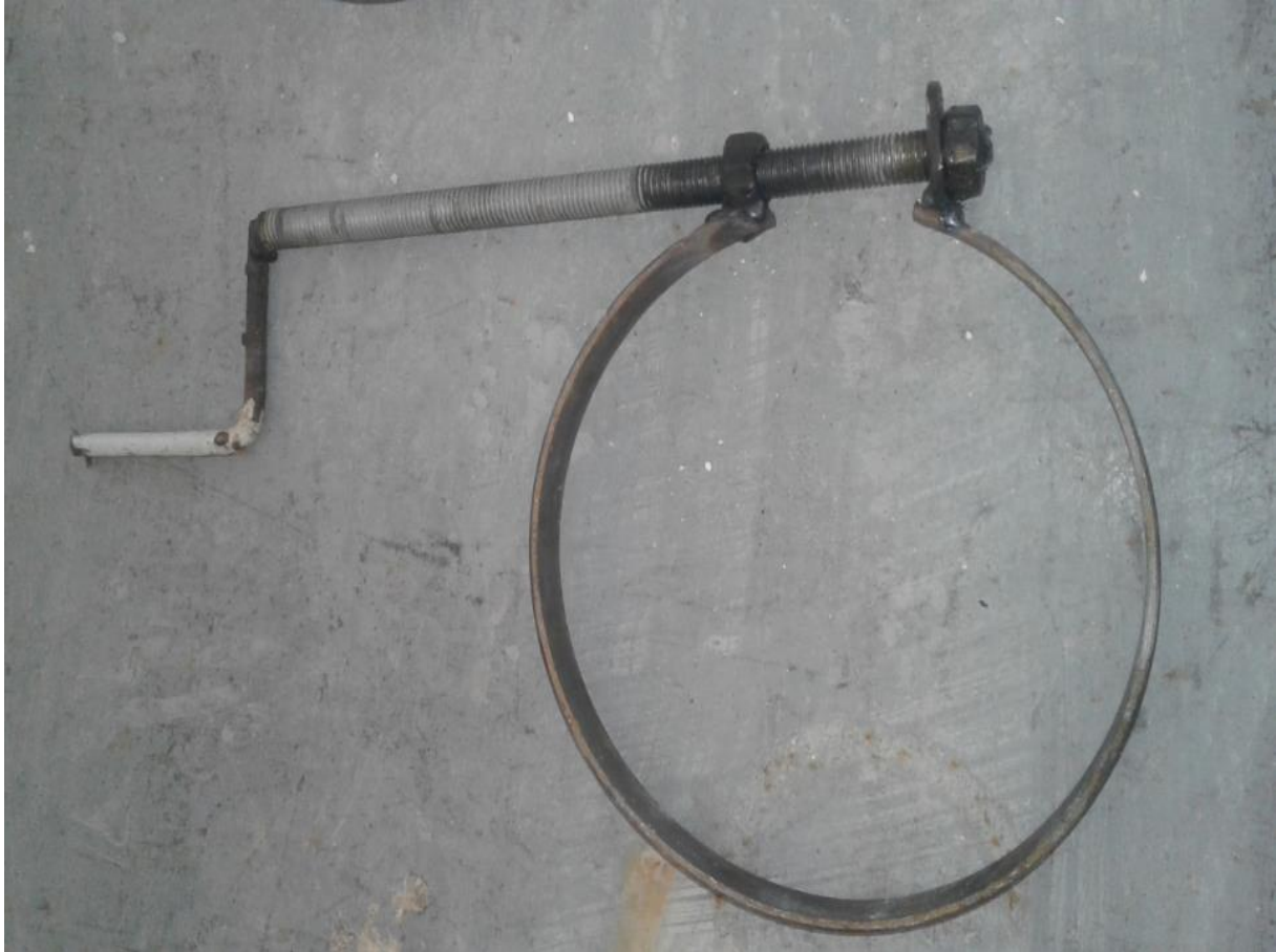
الشكل (3-25) الآلية الخاصة بتطبيق الضغط المسبق على الصفائح الفولاذية الحلقيه
