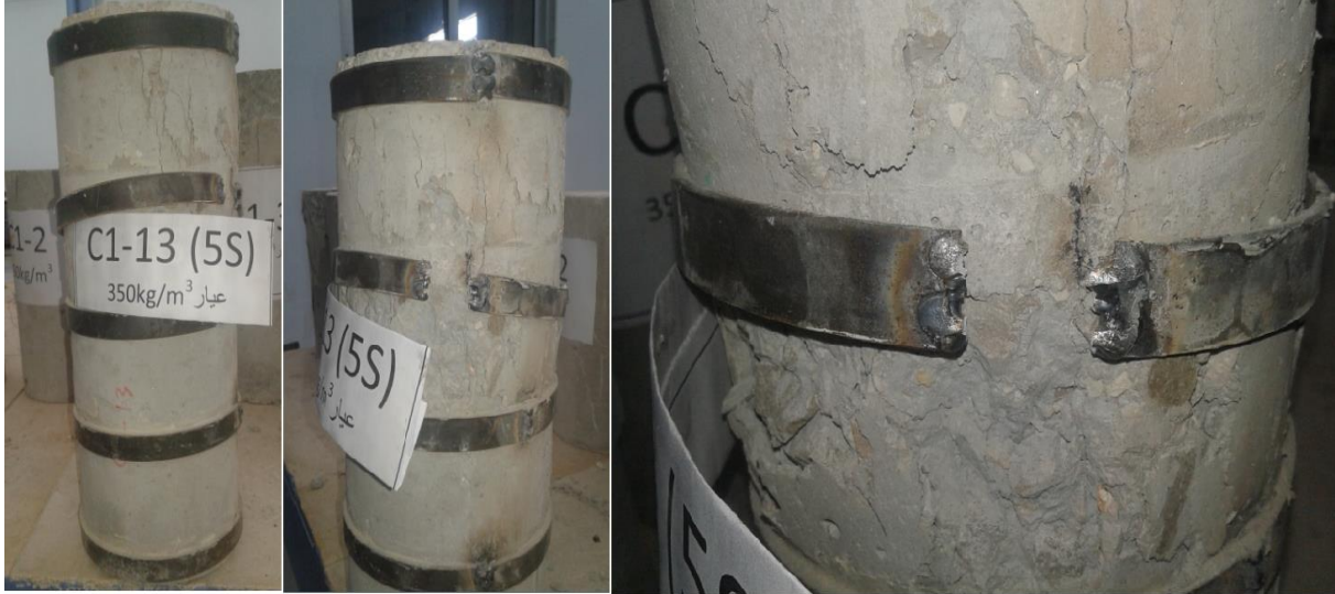
الشكل (3-44) شكل الانهيار للعمود البيتوني المسلح المدعم C1-13
