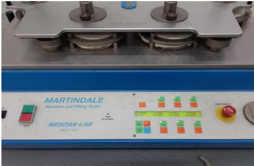
الشكل (7-10) جهاز قياس مقاومة الاحتكاك ISO 12947-1 في مخبر النسيج
