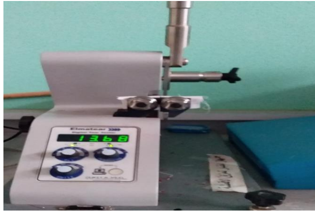
الشكل (7-9) جهاز قياس مقاومة التمزق ASTM D1922 في مخبر الصباغة
