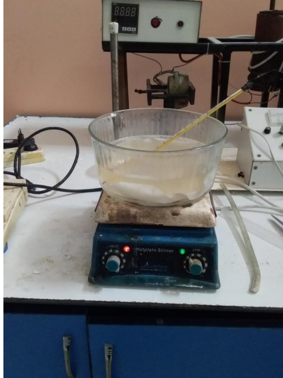
الشكل (2-7) معالجة القماش القطني بالغمر التقليدي في مخبر كيمياء النسيج
