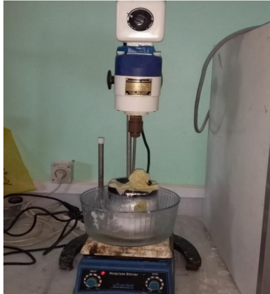
الشكل (7-1) تحضير المستحلب النانوي بالخلط الميكانيكي بسرعة 4000 rpm في مخبر كيمياء النسيج
