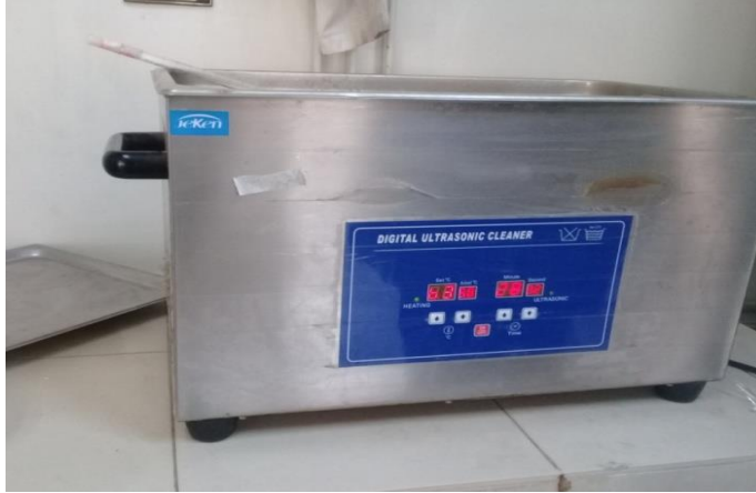
الشكل (7-7) معالجة القماش القطني بجهاز الأمواج فوق الصوتية
