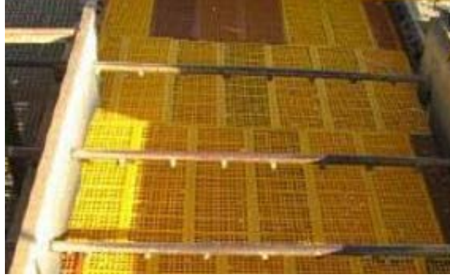
الشكل 3-30: غربال لفصل المواد الناعمة.
