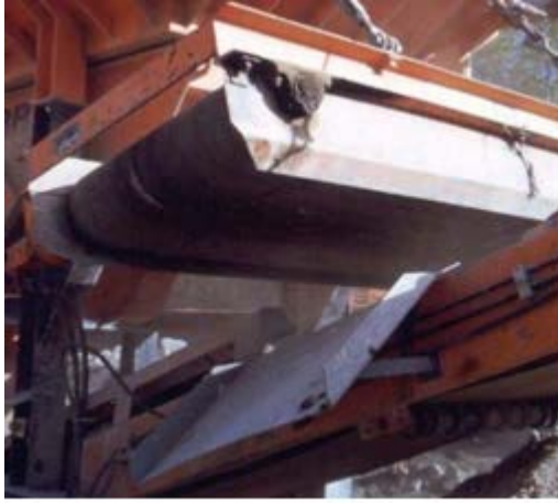
الشكل 3-31: مغناطيس فصل المعادن.
