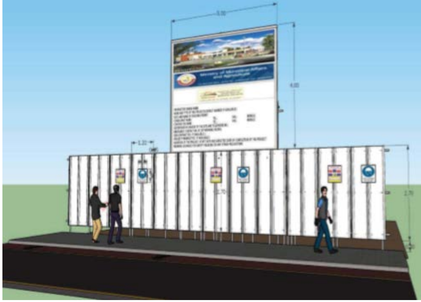
الشكل 3-14: تسوير موقع العمل واللوحة التوضيحي.
