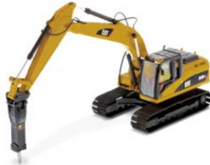
الشكل 3-5: الكسارة الهيدروليكية ذات الذراع الطويلة (القاضمة).
