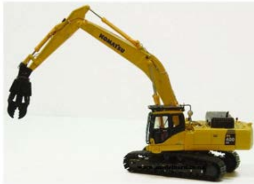
الشكل 3-5: الكسارة الهيدروليكية ذات الذراع الطويلة (القاضمة).
