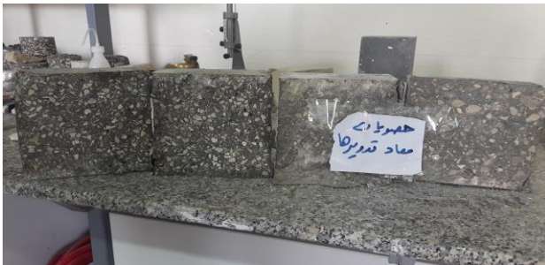
الشكل (4-17) مقارنة بين عينات البيتون التي تحتوي على حصويات معاد تدويرها بعد كسرها على الضغط وعينات من البيتون تحوي على حصويات طبيعية
