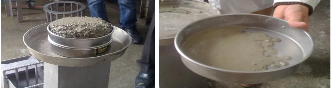
الشكل (1-8) التجهيزات المستخدمة في تعيين ثباتية البيتون بواسطة المنخل
