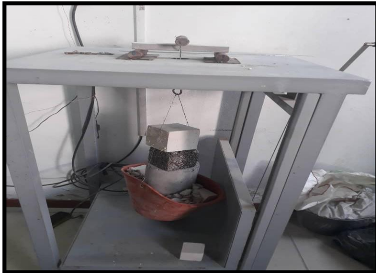
الشكل (3-12) جهاز كسر العينات على الشد بالانعطاف
