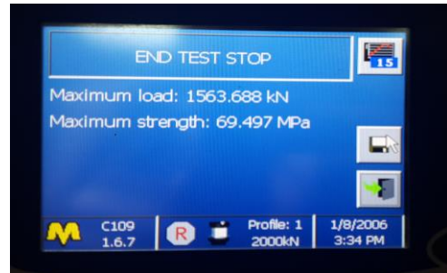
الشكل (3-13) جهاز اختبار العينات البيتونية على الضغط
