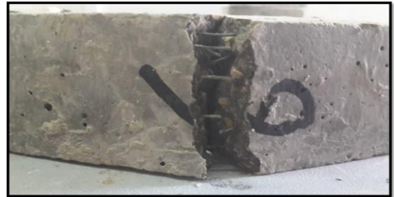
الشكل (3-15) اختبار العينات على الشد بالانقطاع
