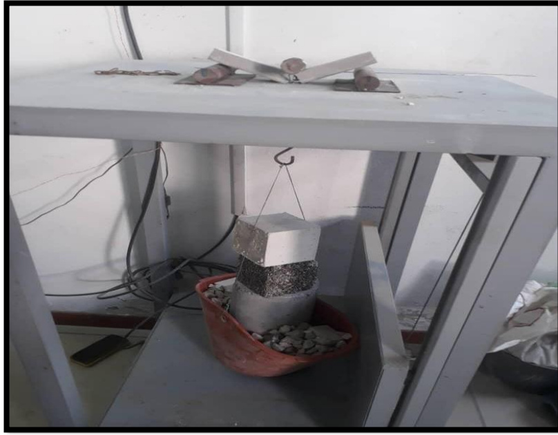
الشكل (3-15) اختبار العينات على الشد بالانعطاف
