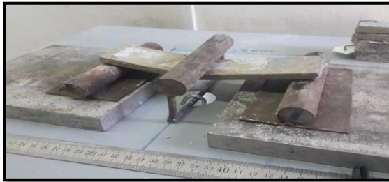
الشكل (3-15) اختبار العينات على الشد بالانقطاع
