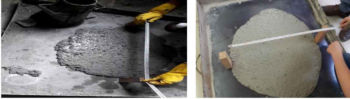
الشكل (1-5) تعيين قطر الانتشار بمخروط أبرامز
