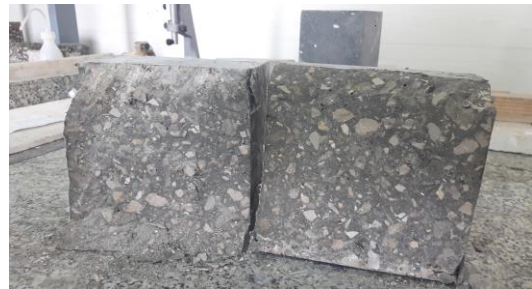
الشكل (3-17) عينات البيتون التي تحتوي على حصويات معاد تدويرها بعد كسرها على الضغط
