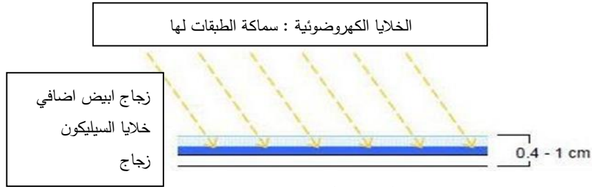
الشكل (1-33) : سماكة الوحدة الكهروضوئية.
