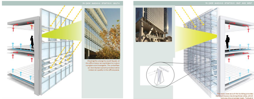
الشكل ( 4-4 ) بعض الصور التوضيحية لكيفية دخول الشمس الى المبنى وتركيب الخلايا امام الواجهات مع وجود فراغ بين الخلايا والواجهات
