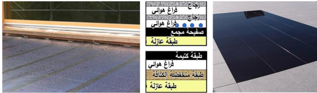
الشكل (3-18): تركيب الأسطح الشمسية كجزء من السقف المستوي الأفقي
